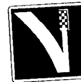
C26a Voie de détresse à droite
